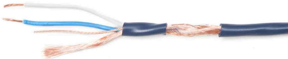
MAGNUM 1022 est une paire de brassage numérique extra souple avec simple guipage, et de section  $2 \times 0,22 \text{ mm}^2$ . La gaine en PVC/NBR apporte une grande souplesse. Son faible diamètre extérieur (3.9 mm) est idéal pour le câblage numérique des baies. L'utilisation de MAGNUM 1022 est fixe, mais il est possible de l'utiliser pour la réalisation de cordons. Ce câble microphone de brassage, idéal pour le montage en baie, peut être utilisé en analogique comme en numérique (AES/EBU).
